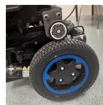
Encoder conectado a la rueda.
