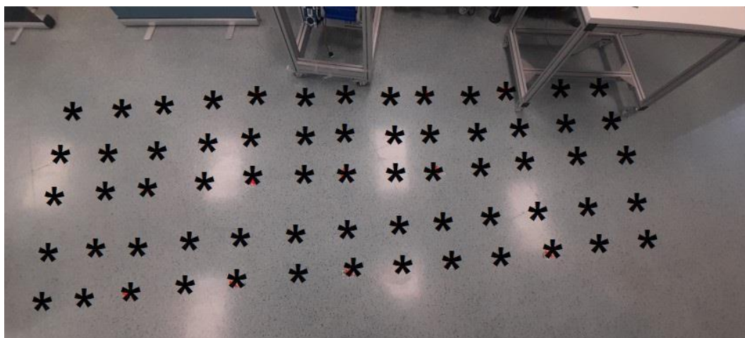
Marcas negras sobre sesenta y cinco posiciones para la calibración
